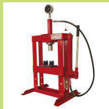
Una prensa hidráulica es un dispositivo mecánico que usa el flujo de fluido (generalmente aceite hidráulico) para generar fuerza y se usa para comprimir diferentes tipos de materiales para compactarlos y finalmente empacarlos.
