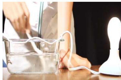
Ilustración 2: Conductividad del agua con Sal
