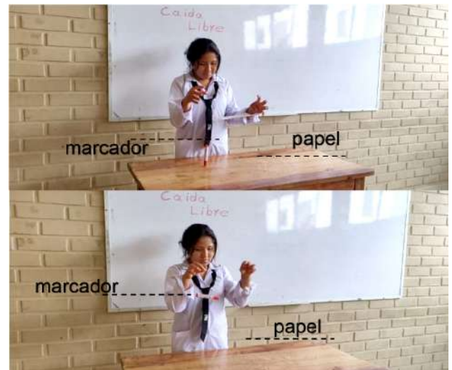
En caída libre, la hoja cae más lentamente debido a la resistencia del aire, mientras que una hoja arrugada cae al mismo tiempo que un marcador, ya que la forma arrugada reduce la resistencia del aire, igualando sus velocidades de caída.
