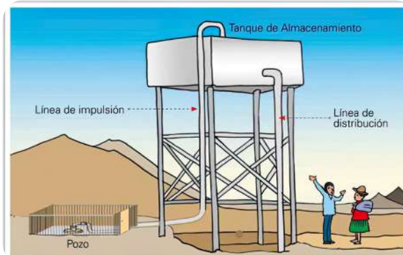
Sistema por bombeo
