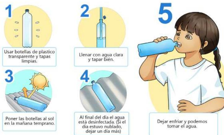
Se logra utilizando la luz del sol y botellas plásticas transparentes incoloras de dos litros de capacidad. La desinfección ocurre cuando actúan los rayos ultravioletas del sol y la elevación de la temperatura del agua.
